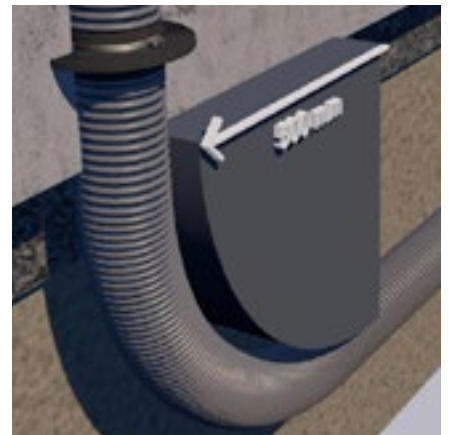
Kabuflex R plus, tip 110 için bükme yarıçapı
